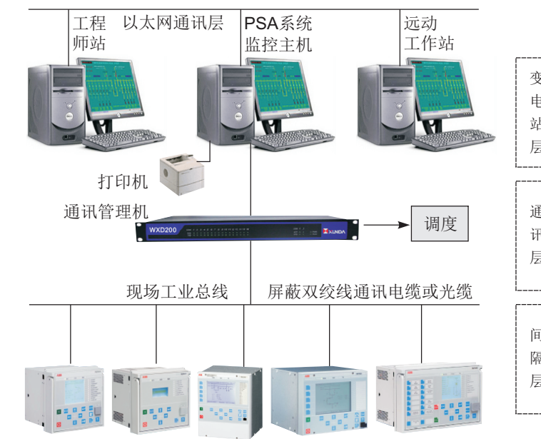
多机监控系统网络结构图
