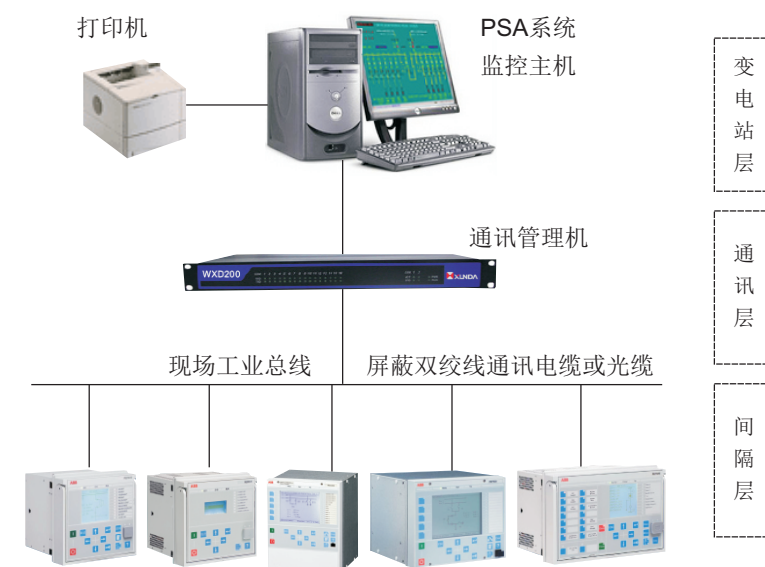
单机监控系统网络结构图
